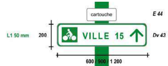
Panneau de pré-signalisation et de position
